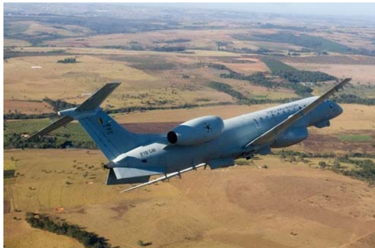
Figura 17 - R-99 Guardiã, capaz de fornecer, em tempo real, imagens e informações eletrônicas sobre objetivos no solo (fonte: CECOMSAER).
