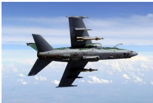
Figura 20 - Aeronave A-1M Falcão configurada com bombas guiadas a laser.
