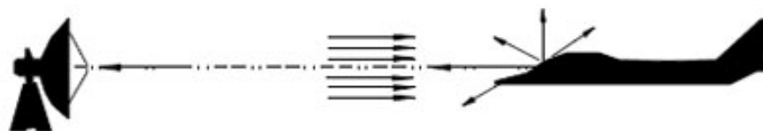
Figura 26 - Reflexão da onda eletromagnética do radar numa aeronave.
